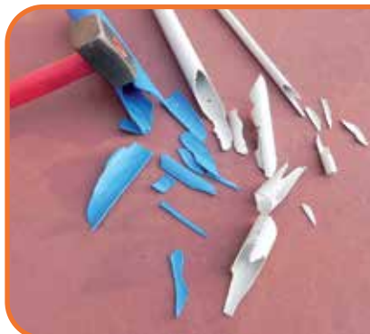
Prova del martello su Tubo NON AAA
