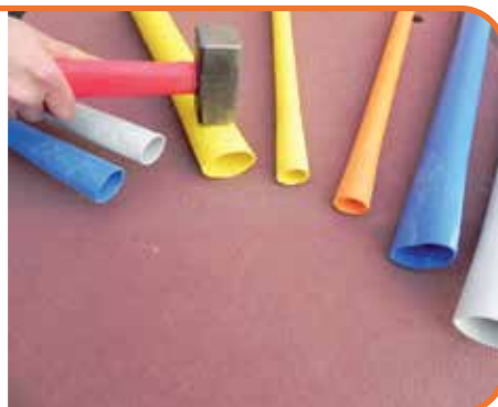
Prova del martello su Tubo AAA che si deforma e non scheggia
